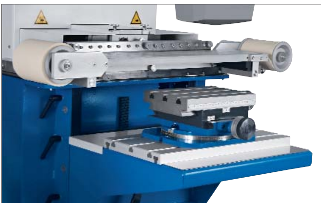
TPE 401 auf Maschinensockel MS 400, mit Verschiebetisch VTP und Verdünnerezuführung TI 300 TPE 401 on machine base MS 400, with shuttle table VTP and thinner injector TI 300
