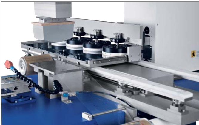
TPX 550 – 6-Farbendruck – mit Transfert Carré und Tamponreinigung TPX 550 – impression 6 couleurs – avec Transfert Carré et nettoyage tampons
