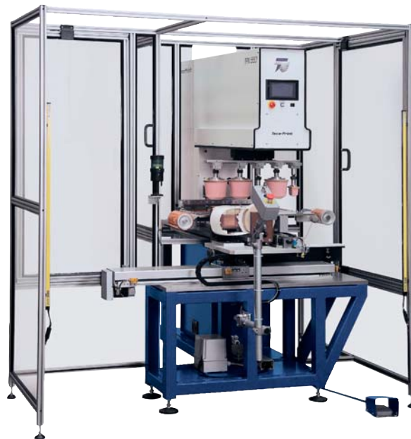
TPX 552 – 2-Farbendruck – mit Topfquerverschiebung TPX 552 – impression 2 couleurs – avec déplacement latéral d'encrier
