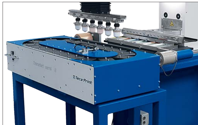
TPX 552 – 2-Farbendruck – mit Topfquerverschiebung TPX 552 – impression 2 couleurs – avec déplacement latéral d'encrier
