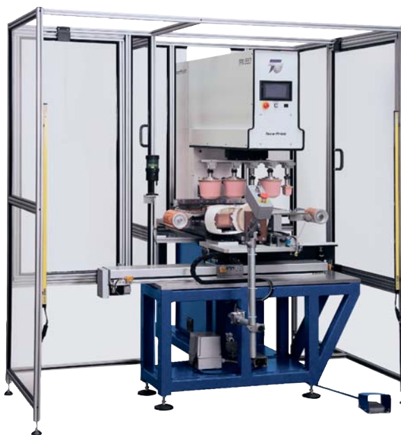
TPX 551 - imprimare in 4 culori cu compensatoare pentru inaltimea tamponului, 3 calimari standard, 1 calimara ovala si dispozitiv de curatare a tamponului
