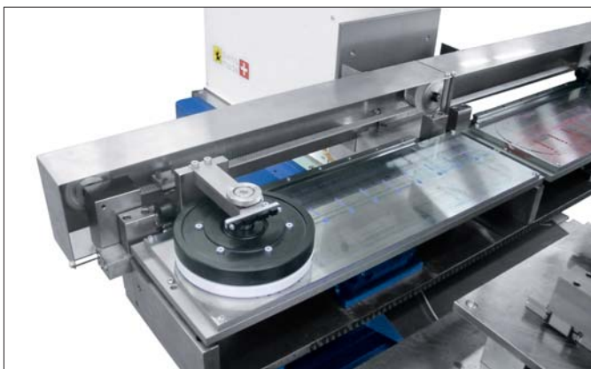
TPX 550 - imprimare in 6 culori - cu Margine de Transfer si sistem de curatare a tamponului
