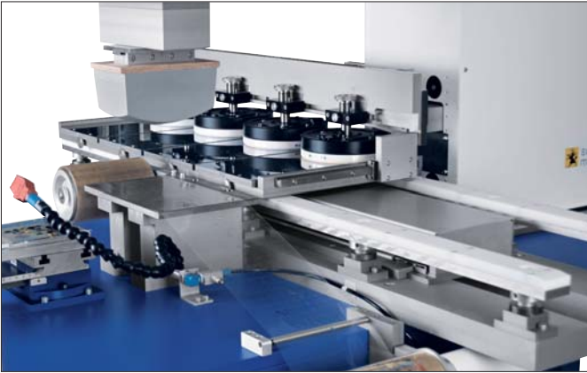
TPX 550 – 6-Farbendruck – mit Transfert Carré und Tamponreinigung TPX 550 – 6 colour print – with Transfert Carre and pad cleaning device
