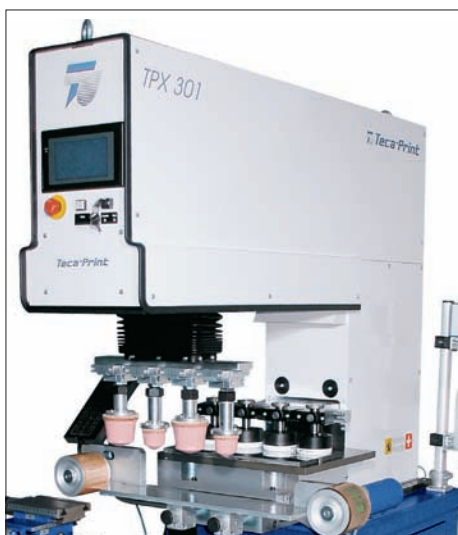
Fig. 5: Machine de tampographie TPX 301 pour impression multi-couleurs.
