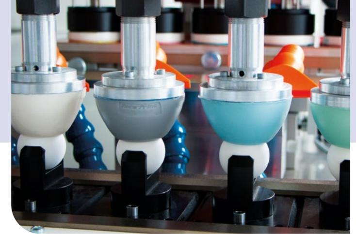
Le tampon joue un rôle clé dans le processus d'impression, en plus d'avoir contribué à donner son nom au procédé. Élément de transfert des encres, le tampon joue un rôle décisif dans la qualité d'impression. Ce n'est qu'avec un transfert d'encre propre, complet et sans déformation qu'on peut obtenir une impression optimale.
